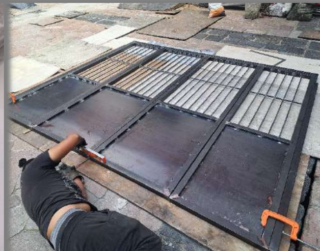
FABRICACION DE PUERTA METALICA A BASE DE PERFILES PTR, CUADRADO Y LAMINA
